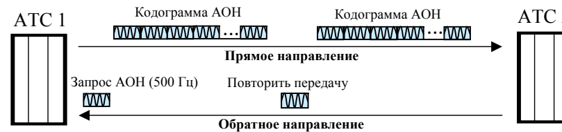
Рис. 23. Обмен многочастотными сигналами по протоколу «безынтервальный пакет»
