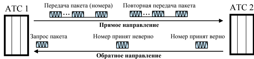
Рис. 22. Обмен многочастотными сигналами по протоколу «импульсный пакет»
